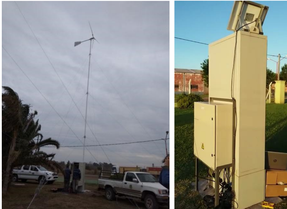
Figura 7: el aerogenerador WINTEC 1500 en ensayo en su emplazamiento (izq.) y sus tableros de control y medición (der.)
