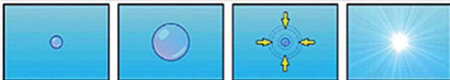
Figura 1 – Da esquerda para a direita: aparição de uma bolha; expansão lenta; contração rápida e súbita; colapso seguido da emissão de luz (BRENNER et al., 2002).
